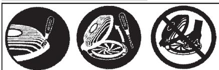
**⚠ AVERTISSEMENT:** Arrêtez le moteur avant d'ouvrir l'arrivée d'aspirateur. Le moteur doit être arrêté et les lames de l'impulseur ne doivent plus tourner pour éviter les blessures graves que peuvent causer les lames qui tournent. Soulevez doucement le bout du tournevis vers l'arrière de l'appareil à ouvrir la loquet en tirant sur le couvercle de l'arrivée de l'aspirateur avec l'autre main.
